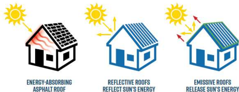
Gambar 1: Skema prinsip kerja atap konvensional, reflektif, dan emisif terhadap radiasi surya. (Sumber: https://www.mcelroymetal.com )
