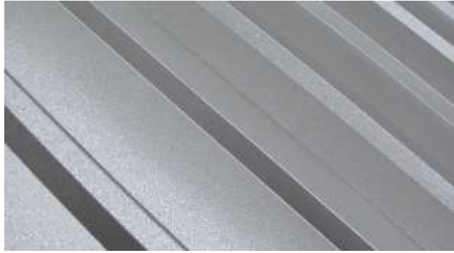
Gambar 3: Lembaran galvanis yang dilapisi bonder dan pernis (Sumber: https://steelscape.com )
